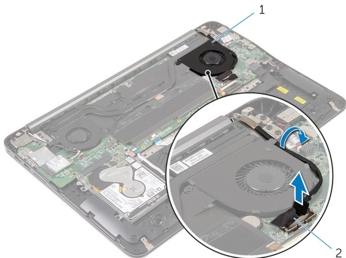
1 el ventilador del procesador      2 Cable de la pantalla
